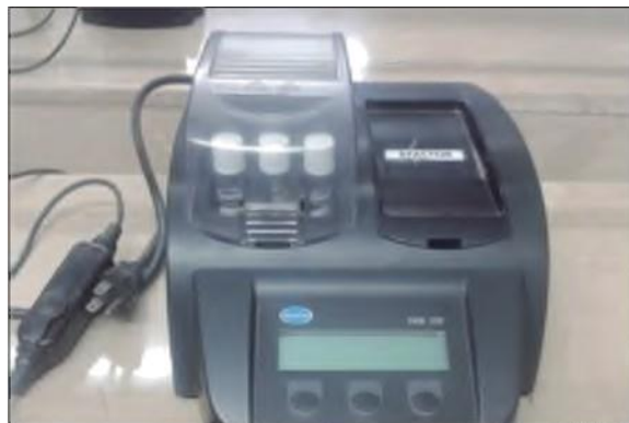
Ilustración 2. Reactor para DQO. Motco I—Bach. Moaelo DRB-200
