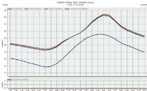
Máxima exterior 31.2° 17hora Máxima interior 35.7° 17horas
