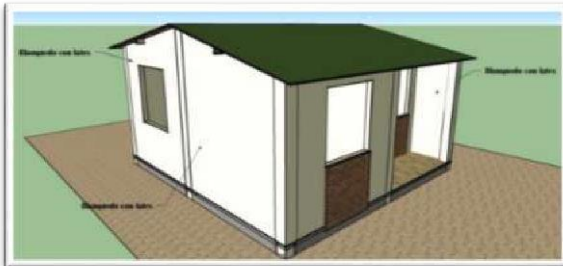
Blanqueado de paredes revocadas
