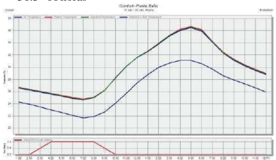
Temperatura en Sala, Comedor y Cocina exterior 31.2° 16horas 36.3° 16horas
