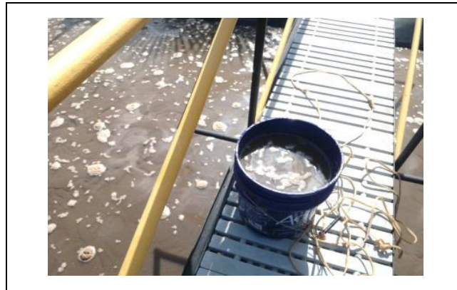
Figura 2. Toma de inóculo de lodo activo de la laguna de aireación de la PTAR Terranostra
