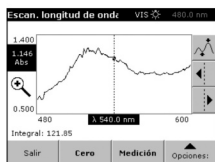
Figura 9: Medición absorbancia pantalla DR5000
