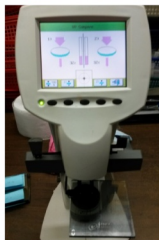
Figura7: “Lensometro” configurado para medición de porcentaje de tramicion uv
