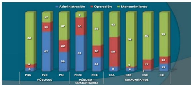
**Figura 1.** Peso relativo de los costos de los sistemas de riego en administración, operación y mantenimiento.
