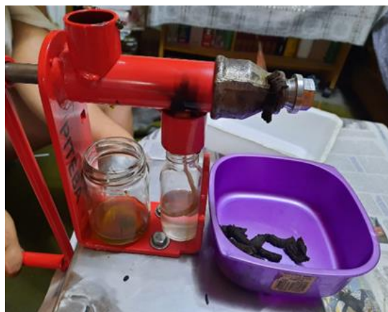
Fig 1. Prensa Piteba, presado en caliente con mechero de alcohol etílico
