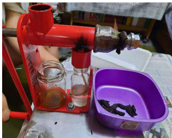
Fig 1. Prensa Piteba, prensado en caliente con mechero de alcohol etílico
