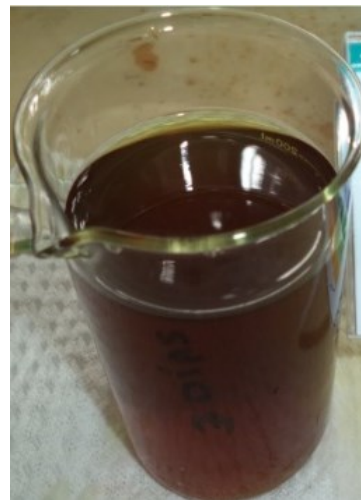
Fig. 6. Solución de (AgNPs) sintetizadas a partir de extracto de hojas de romero como agente reductor de la plata (Ag)
