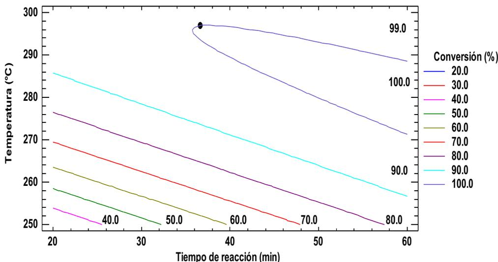
**Figura 2.** Gráfico de contornos de la superficie de respuesta estimada para la reacción de hidrólisis en función de la temperatura y el tiempo de reacción.
