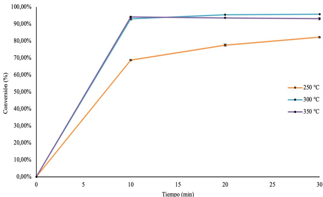
**Figura 3.** Conversión en la esterificación de ácidos grasos a diferentes temperatura y tiempos de reacción a 10 MPa y una relación molar 10:1
