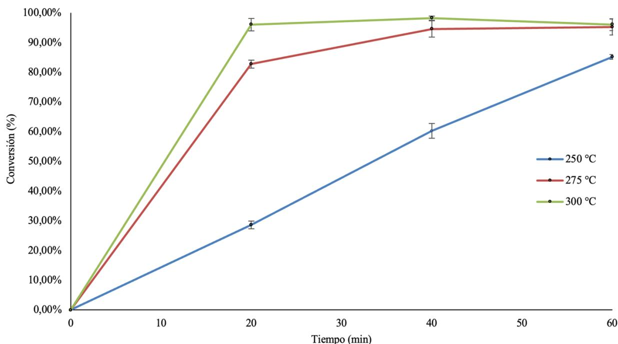
**Figura 1.** Conversión en la hidrólisis de aceite usado de cocina a diferentes temperatura y tiempos de reacción.
