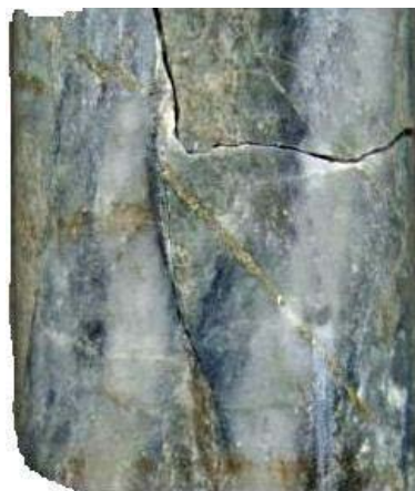
Figura 14. Muestra de mano, con vetilla qz - mo (A2), en pórfido temprano (Jefp), cortada por vetilla de sulfuros (D1), y ambas cortadas por vetilla de yeso
