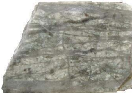
Figura 12. Muestra de mano, con vetillas agudas (A1), en pórfido temprano (Jefp)
