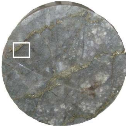
Figura 27. Muestra de mano, con 3 vetillas de sulfuros (D2), en misma dirección, en granodiorita (Jzgd),
