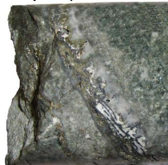
Figura 30. Muestra de mano, con vetilla polimetálica, en granodiorita (Jzgd).
