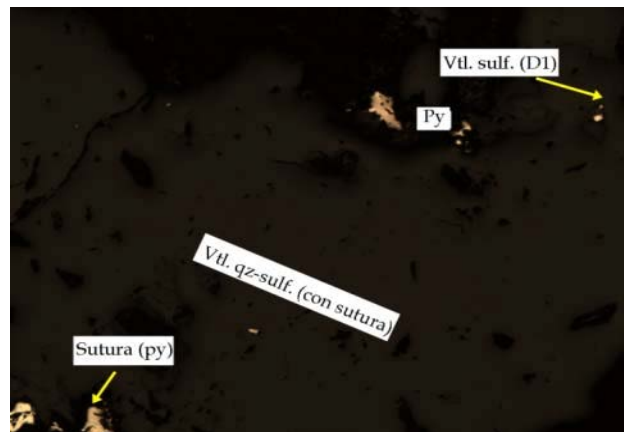
Figura 22. Zoom (50x), Luz reflejada, se puede observar en la parte superior derecha, Py en halo de alteración sericítico de vetilla de sulfuro (D1), y también Py en sutura de Vetilla de qz – sulfuro (con sutura), (esquina inferior izquierda).
