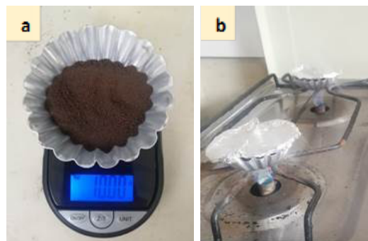
Fig. 8. Determinación de materia orgánica del suelo: a) pesado de la muestra b) calcinación de la muestra
