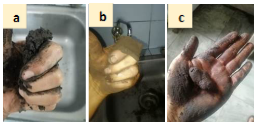
Figura 5. Determinación de la textura del suelo: a) Suelo franco arenoso b) Suelo franco limoso c) Suelo franco arcilloso limoso.
