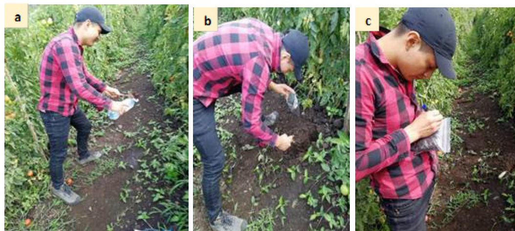
Figura 3. Metodología de campo utilizado para la extracción de muestras de suelo agrícola: a) Esterilización de utensilios b) Colecta de muestras c) Rotulado.
