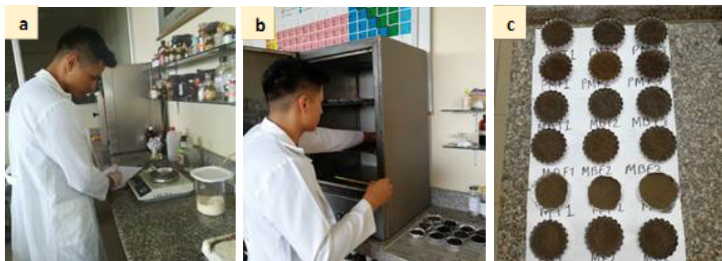
Figura 6. Determinación del porcentaje de humedad: a) pesado de muestras b) introducción de las muestras al horno de secado c) muestras post secado.
