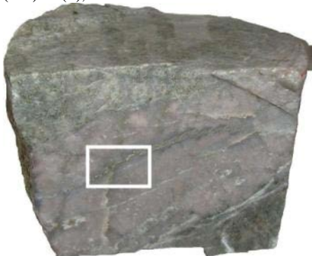
Figura 20. Muestra de mano, con vetilla qz – sulfuros (con sutura), en granodiorita (Jzgd).
