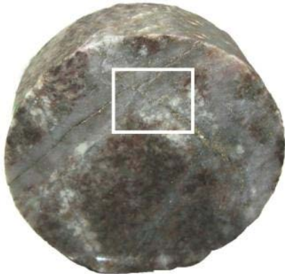
Figura 23. Zoom (50x), Luz reflejada, se puede observar en la parte superior derecha, Py en halo de alteración sericítico de vetilla de sulfuro (D1), y también Py en sutura de Vetilla de qz –sulfuro (con sutura), (esquina inferior izquierda).
