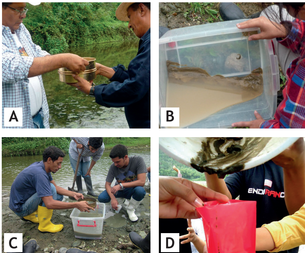
Figura 1. Proceso de muestreo (A), efectuando la tamización (B-C) y decantación del sedimento bolsa de polietileno (D).
