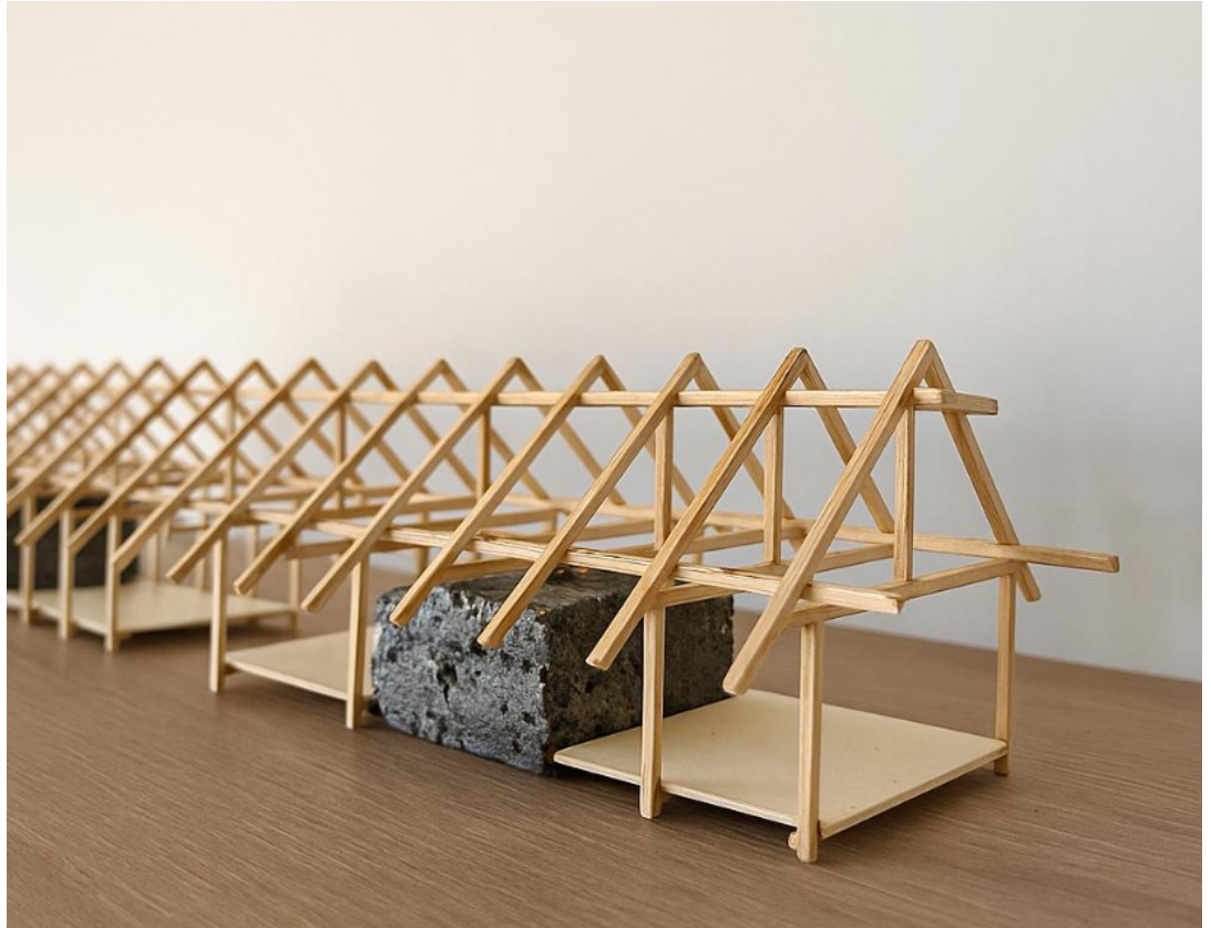
Figura 10: Maqueta arquitectónica de equipamiento comunitario con estructura modular de madera.
